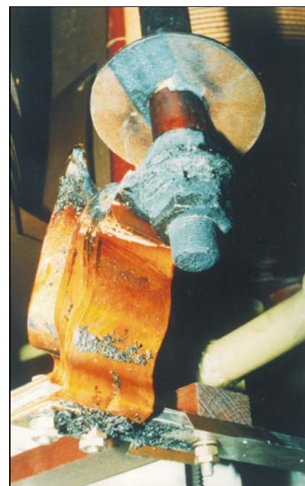
Bild 6 Schaden an einem 110/10 kV Transformator durch Überhitzung
